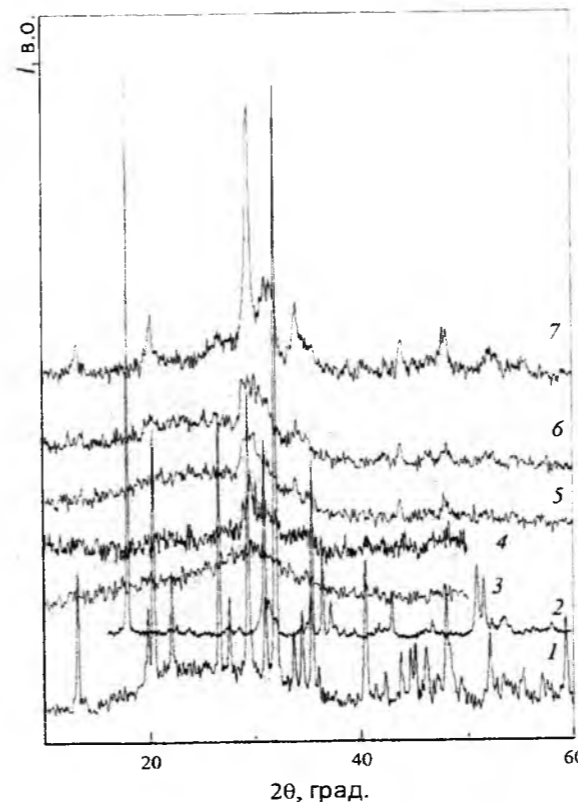
Рис. 6. Дифрактограми полікристалічних SbSeI (1) та As_2Se_3 (2), свіжоприготованого (3) та відпалених (4-7) стекло (As_2Se_3)_{20}(SbSeI)_{80} . Температура T_g і час \tau_g відпалу: 4 – 423 К, 1 год.; 5 – 423 К, 5 год.; 6 – 423 К, 7 год.; 7 – 483 К, 0,1 год.
