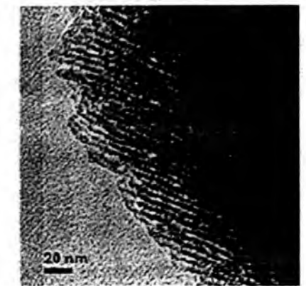
Рис. 4. ТЕМ-зображення нанодротин Si-C [43].
